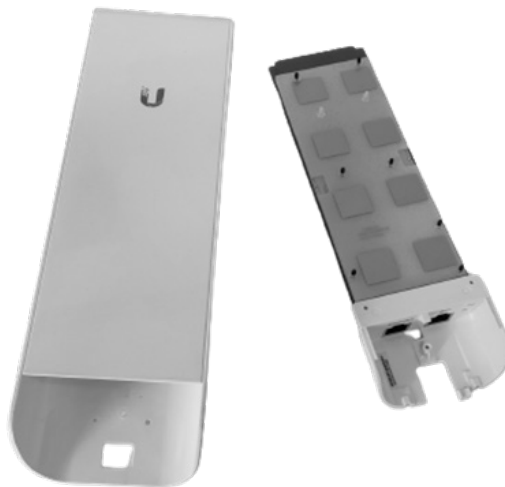
Figura 4.2 -Arreglo de antenas airMAX NanoStation M5 Fuente: propia
