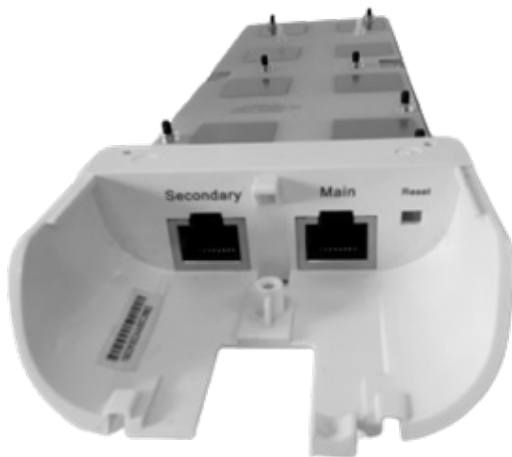
Figura 4.4 -Sección de networking del airMAX NanoStation M5 Fuente: propia
